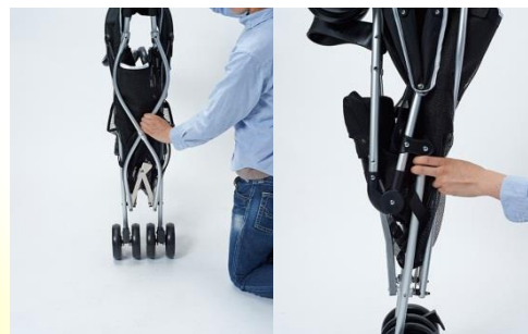
指はさみ防止フレーム 背面パイプをカーブさせたフレームや関節部のヒンジを大型化し、指はさみを防止
