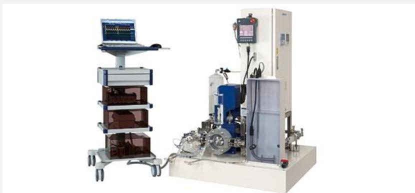
心臓の拍動波形を再現し、補助人工心臓等の性能評価や耐久試験を行う装置
