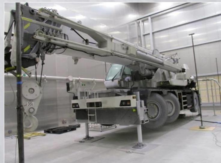
低温での実機試験中
